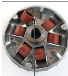
正确装配：从内侧向外看，所有滚子按图示位置摆放，露铁面在右侧，塑料包裹面在左侧。
